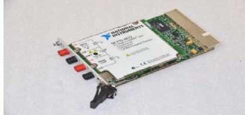
Նկ.3. NI PXI-4072 (ունակության չափիչ սարք)
